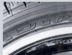
Usure liée au sous-gonflage
